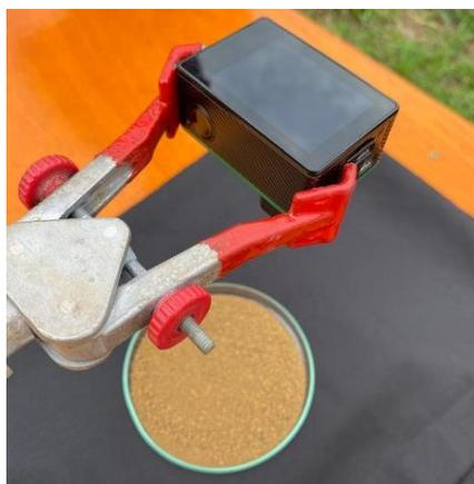
Figura 2. Processo de captura das imagens por meio da câmera Mapir Survey 3W.
